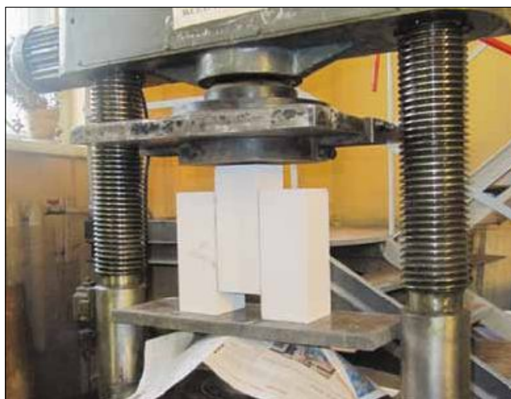
Рис. 4. Образец для испытания на срез
