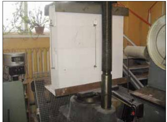
Рис. 8. Фрагмент кладки на испытательном стенде
