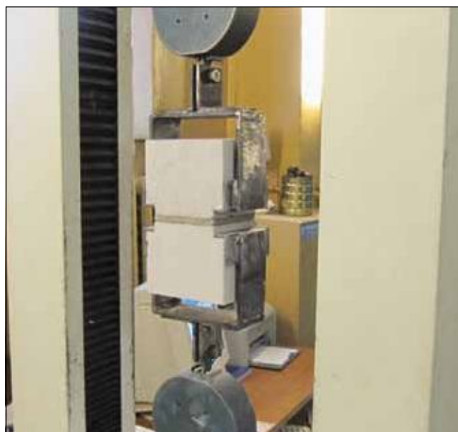
Рис. 2. Образец для испытания на адгезию
