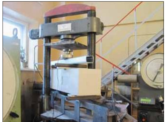
Рис. 6. Образец для испытаний на изгиб
