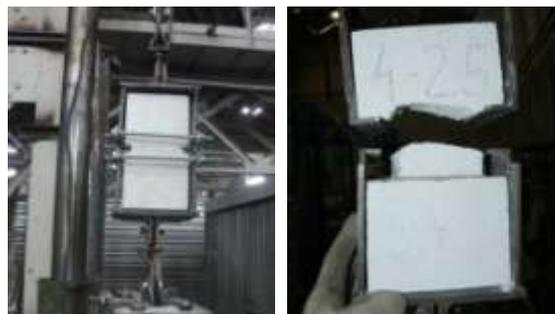
**Определение нормального сцепления в кладочном шве**
