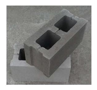
ГОСТ 6133 «Камни бетонные стеновые». Рядовой камень марок M25-M75 F25 Плотность (брутто) 850-1100 кг/куб.м (пустотность 35-45%)
